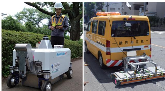
歩道探査ロボット（左）とキャリア積載型地中レーダシステム（右）
